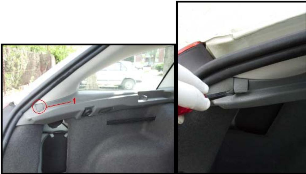
Figure 31 : Photos du cache de la vis de fixation de la garniture.
