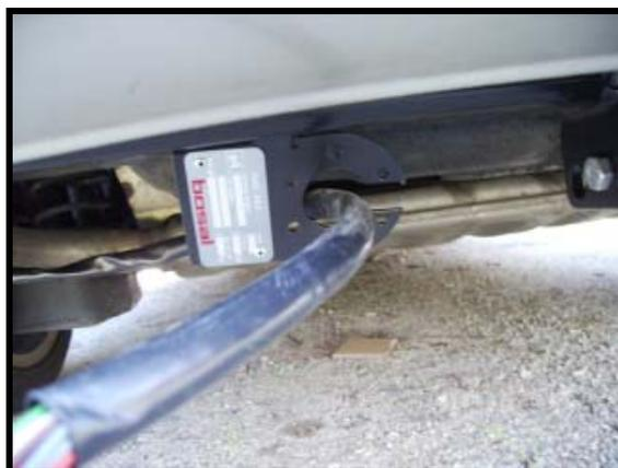
Figure 44 : Photo du câble de la prise de l'attelage.
