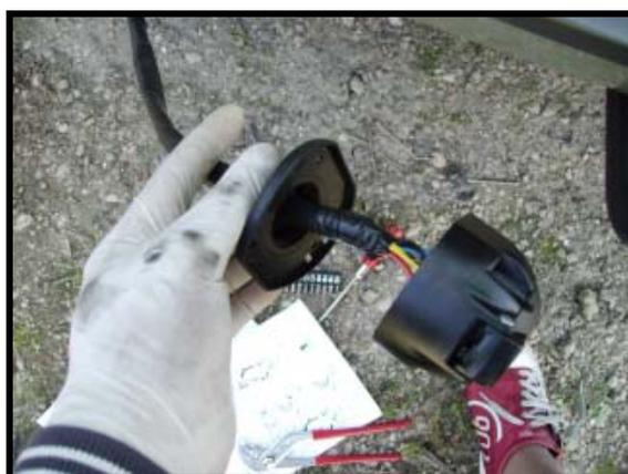
Figure 48 : Photo de la prise de l'attelage au complet.
