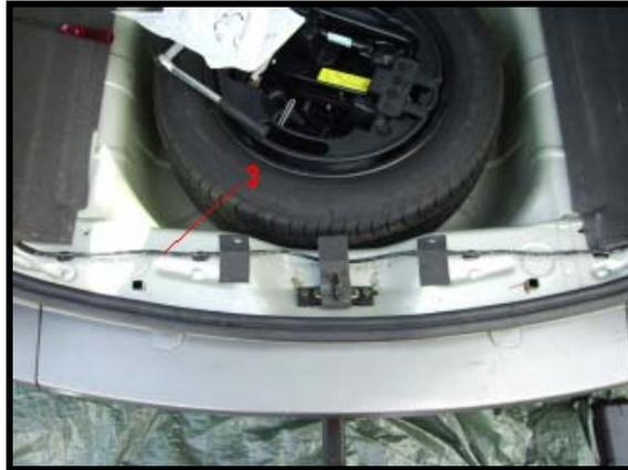
Figure 28 : Photos montrant le câble reliant les deux blocs de feux arrière.
