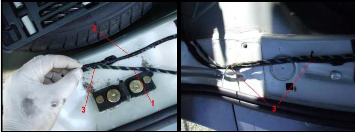
Figure 42 : Photos du passage du câble de l'attelage.
