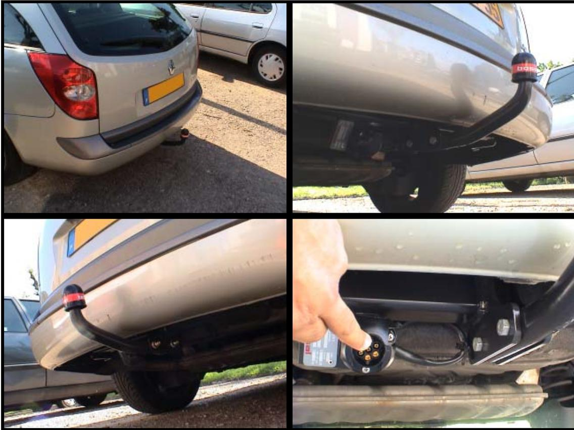
Figure 52 : Photos du résultat du montage de l'attelage.
