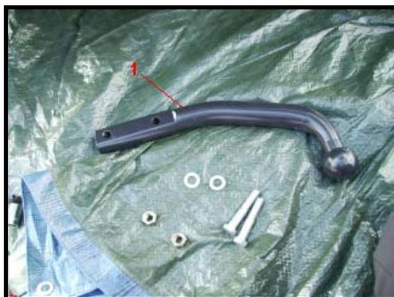
Figure 21 : Photo illustrant l'attache en « col de signe » et sa visserie.
