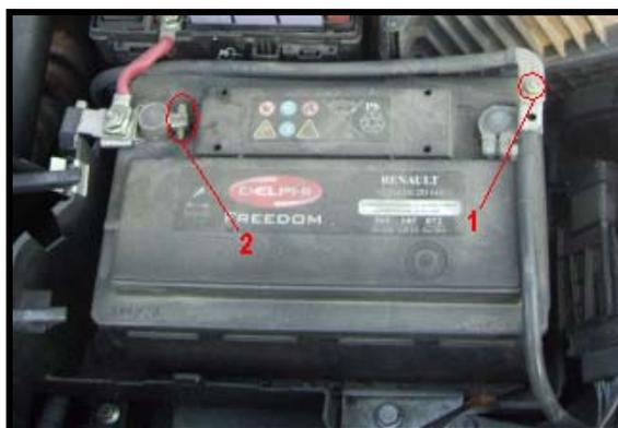
Figure 8 : Photo illustrant la déconnexion de la batterie.
