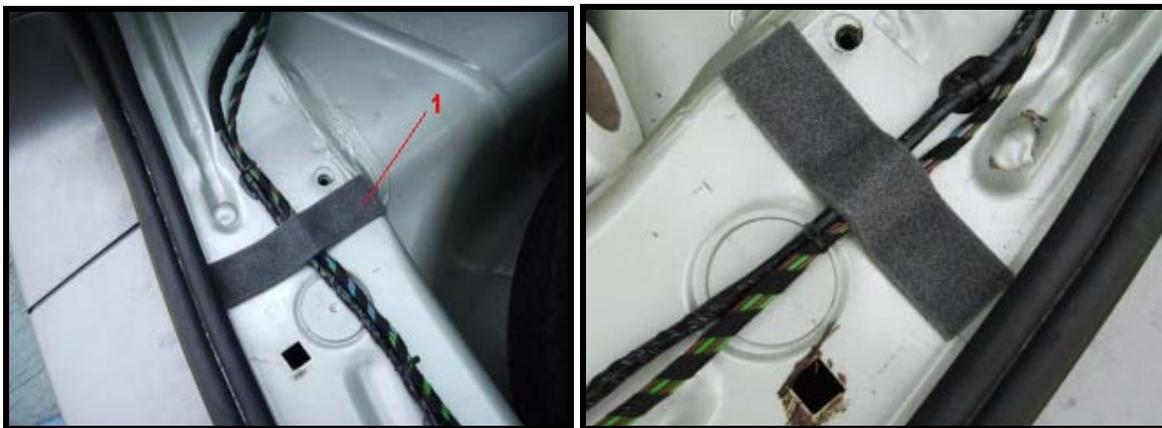
Figure 43 : Photos de la bande protectrice en mousse.
