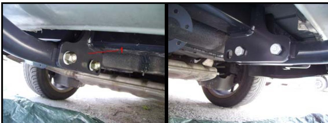
Figure 22 : Photos de la fixation de l'attache.
