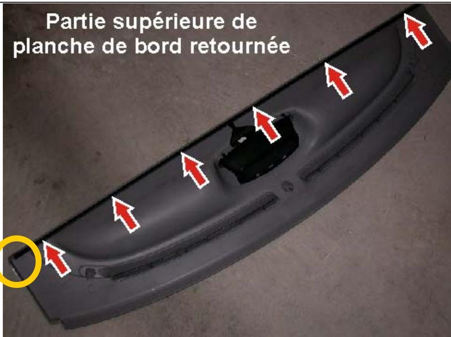
**Fig. 3:** Localisation du joint de caoutchouc sous la partie supérieure de la planche de bord retournée.
