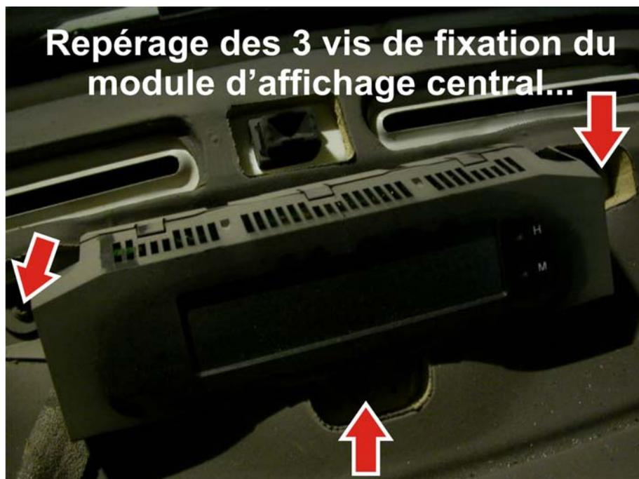
**Fig. 6:** Afficheur central fixé par 3 vis Torx.
